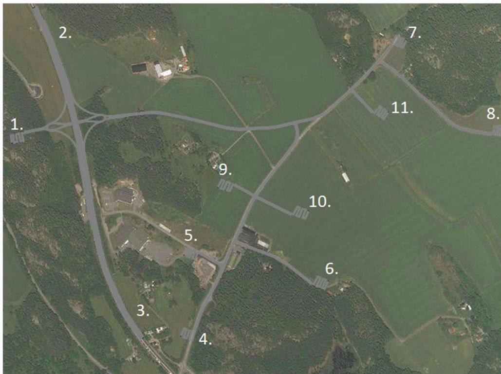
Figur 2 - Modellens utbredning där nod 9–11 representerar Akvedukten verksamhetsområde, nod 5 befintlig verksamhet, nod 6 ny återvinningscentral (ÅVC) och nod 2–3 E22. Övriga noder är befintliga vägar.
